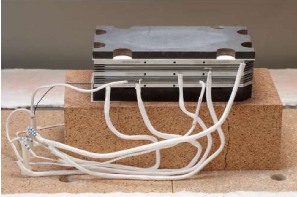
Rekord-Brennstoffzellen-Stack am Forschungszentrum Jülich
